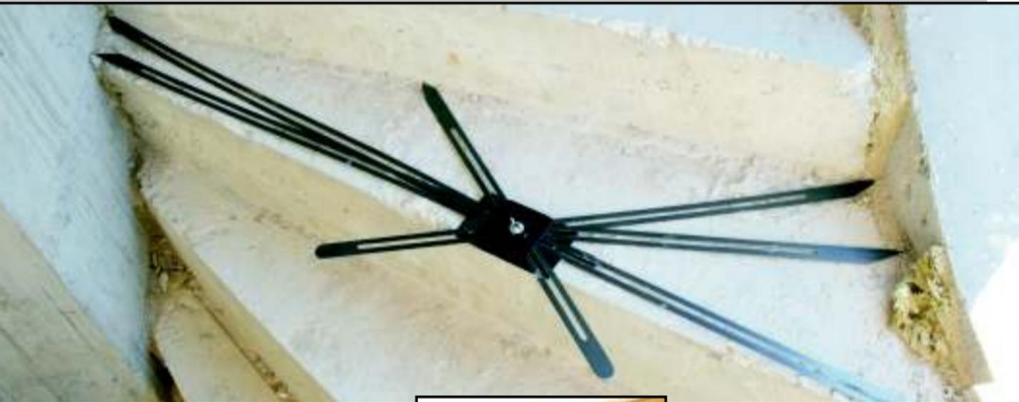
Die sechs Tastlehren der Treppenspinne sind aus gehärtetem Federbandstahl, je zwei Tastlehren von 60, 80 und 100 cm Länge. Die Treppenspinne ist eine Alternative zur Winkelschablone.
