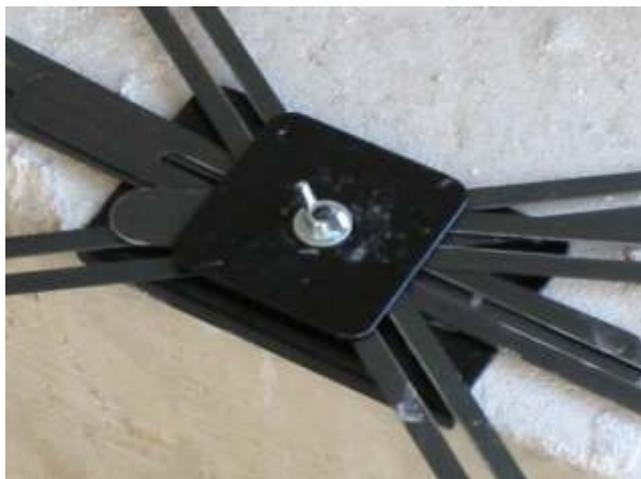
**Der Winkelanschlag der Grundplatte ermöglicht ein sauberes Anlegen an den Stirnseiten**
