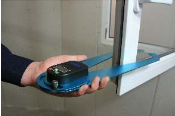
Ermitteln von Glasdicken im eingebauten Zustand
