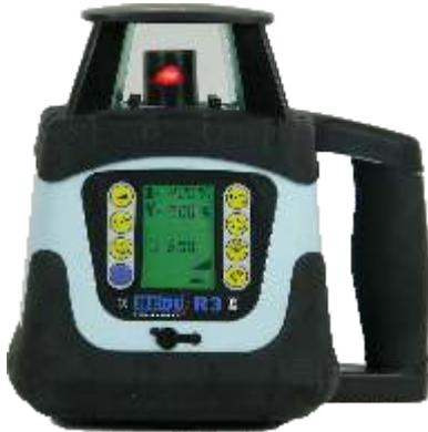
Der digitale Vollautomat hedue R3 kombiniert alle Funktionen eines Rotationslasers mit einer digitalen Steuerung. Zum Einrichten von Gefälle und Neigungen können Sie Ihre Vorgabewerte mit einer Auflösung von 0,01 % einstellen. Der R3 fährt die gewählte Einstellung auf Knopfdruck vollautomatisch an. Effizienter und genauer geht es nicht. Beide Achsen lassen sich jeweils auf bis zu 10 % neigen. Die Neigung beider Achsen gleichzeitig ist bis zu einem Wert in der Summe von 13 % möglich.
