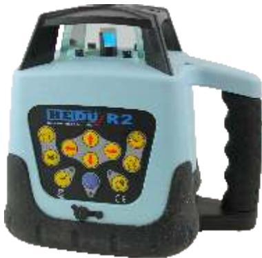
Der Rotationslaser hedue R2 ist ein horizontaler und vertikaler Vollautomat. Er richtet sich zu beiden Achsen in einem Selbstnivellierbereich von 5° automatisch aus. Egal ob Regelung der Rotationsgeschwindigkeit, manuelle Neigung der X- und Y-Achse oder Veränderung der Linienlänge. Alle wichtigen Funktionen lassen sich ganz praktisch über die Fernbedienung steuern. Sie können also auch Gefälle von Konstruktionen oder Unterbauten und Schüttungen mit dem R2 ganz einfach realisieren.
