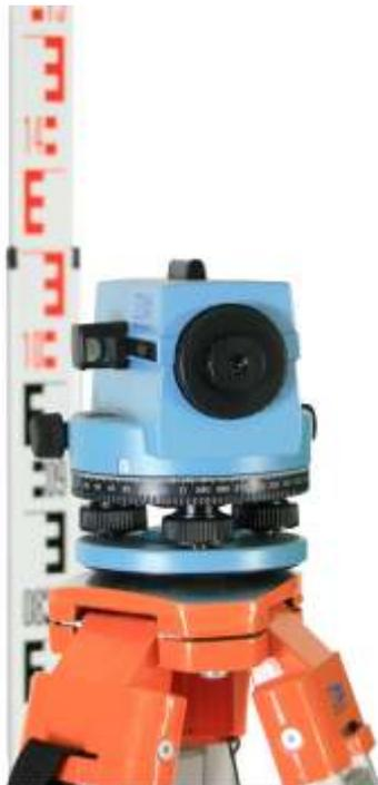
Passgenau für jedes Nivellierstativ mit 5/8"-Gewinde.
