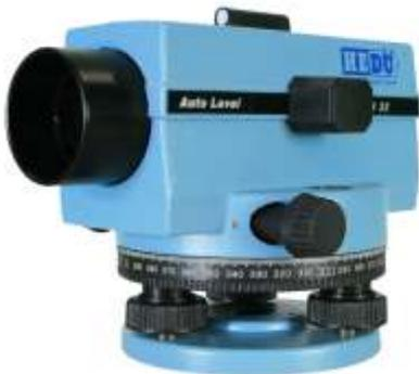
Dank der verbauten Kompensatoren stellen sich die optischen Nivellieren automatisch in der Waagerechten ein. Vorab ist lediglich die Ausrichtung der Nivelliere mittels der Dosenlibelle, welche ganz bequem über das Spiegelvisier abgelesen werden kann, vorzunehmen. So haben Sie jederzeit alles fest im Blick. Mittels der Fußschrauben bringen Sie das Gerät problemlos in die Waage.
