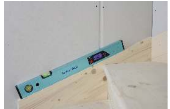
Einfaches Abnehmen von Neigungen in Grad, mm/m und Prozent.
