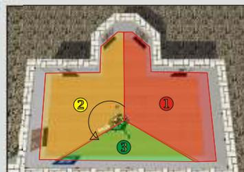
360° Arbeitsbereich mit dem Rotationsadapter. Einfaches Nachführen der Laserlinie auch in großen Räumen.
