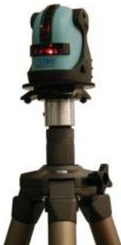
Der Rotationsadapter schafft Verbindung mit Stativen oder dient als bewegliche Gerätekonsole bei Bodenarbeiten
