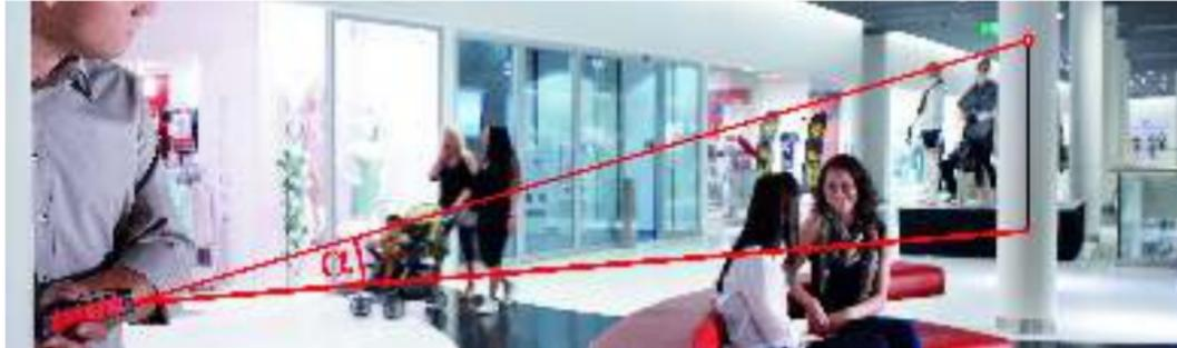
Ab dem X310 messen die Leica Disto gleichzeitig Entfernung und Neigung. Dadurch kann die horizontale Entfernung auch über Hindernisse hinweg gemessen werden.
