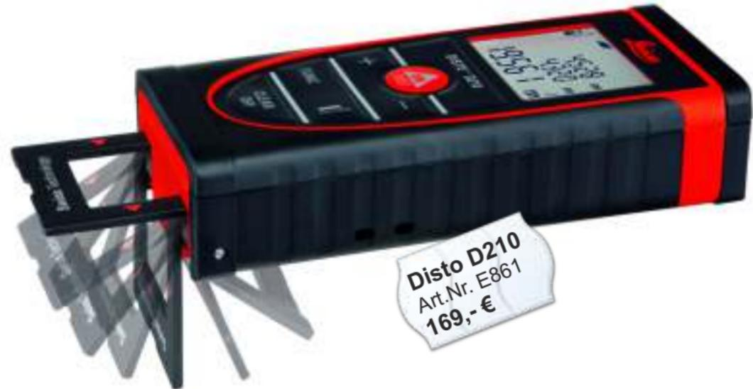
Alle Leica Disto haben ein multifunktionales Endstück. Bei dem Disto D2 wird die Position des Endstückes (Messanfang) mittels Tastatur eingestellt. Ab dem D210 wird die Position des Endstückes vom Gerät automatisch erkannt. Messfehler werden dadurch vermieden.
