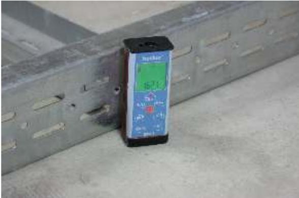
Der Lasermeter EM1 mit einem Messbereich von 5 cm bis zu 50 m und einer Genauigkeit von 1,5 mm das ideale Gerät für den Innenbereich. Dank seines Taschenformates (114 x 47 x 32 mm) ist der EM1 jederzeit fürs Aufmaß griffbereit.
