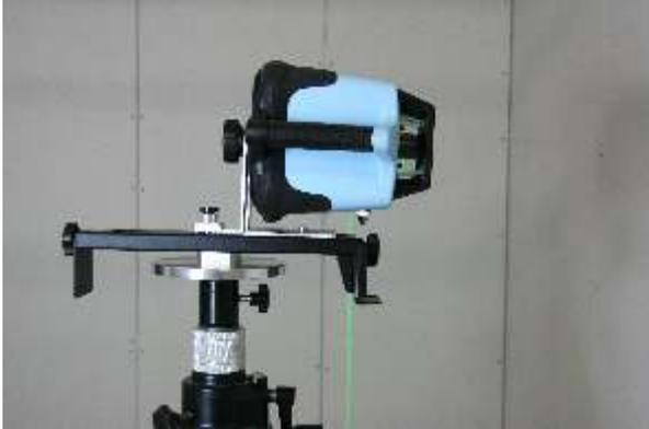
Vertikalhalterung für Rotationslaser auf Stativ
