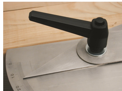
nogi mogą być mocowane za pomocą dużej dźwigni zaciskowej
