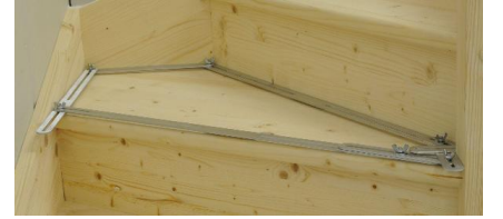
Çokgen konturları iş parçalarına aktarmak için
