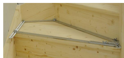
Zum Übertragen von vieleckigen Konturen auf Werkstücke
