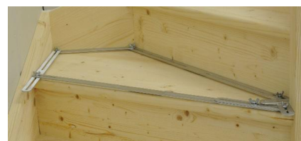
Do przenoszenia konturów wielokątów na obrabiane elementy
