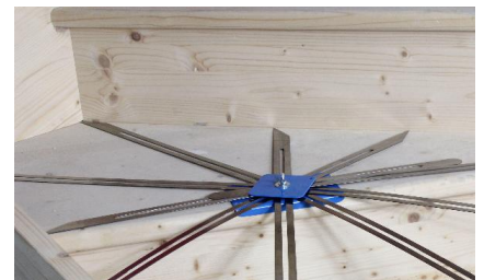
Einfaches Abtasten der Form von Treppenstufen.
