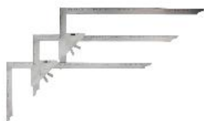
Wysokość i szerokość stopni są regulowane indywidualnie.
