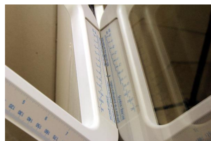
Messung von Glasdicken durch Spiegelung in der Scheibe
