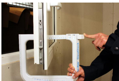
Mesure d'épaisseur de vitrage simple et isolant
