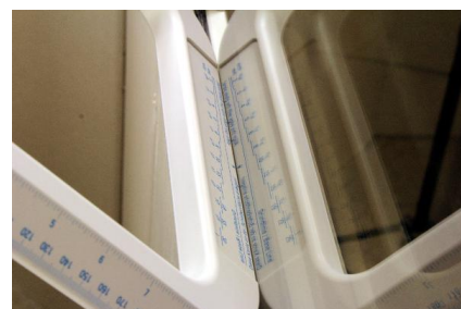
Mesure de l'épaisseur du verre par réflexion dans la vitre
