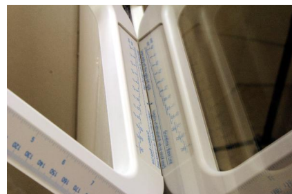
Măsurarea grosimii geamurilor prin reflexia în ochiul de geam
