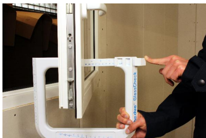
Măsurarea grosimii geamurilor simple și a geamurilor izolate
