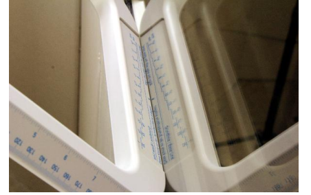
Cam kalınlıklarının bölmedeki yansıma ile ölçülmesi
