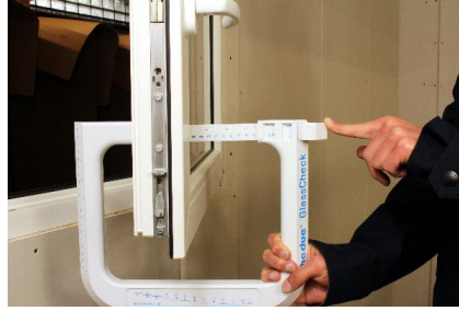
Tek ve yalıtım camının kalınlık ölçümü
