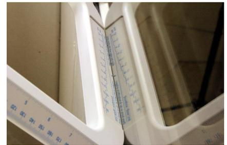
Medição da espessura do vidro por reflexão no painel
