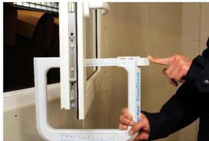
Medição da espessura do vidro simples e isolante
