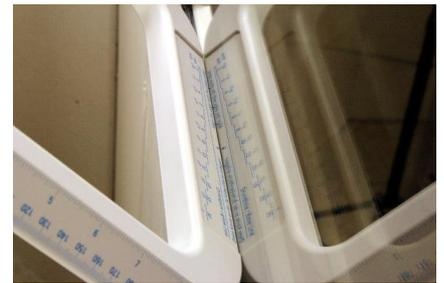
Mesure de l'épaisseur du verre par réflexion dans la vitre
