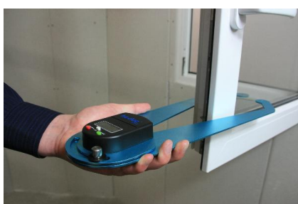
Łatwe mocowanie ościeżnicy drzwi lub okna w celu określenia grubości ściany lub grubości szkła
