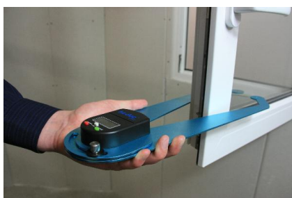
Saisie facile du cadre de la porte ou de la fenêtre pour déterminer l'épaisseur de la paroi ou du verre
