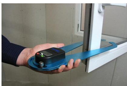
Împresurare ușoară a tocurilor de ușă sau a ramelor ferestrelor pentru determinarea grosimii peretelui sau a grosimii sticlei
