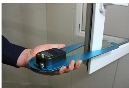
Gemakkelijk vastpakken van deurkozijn of raamkozijn om de wanddikte of glasdikte te bepalen
