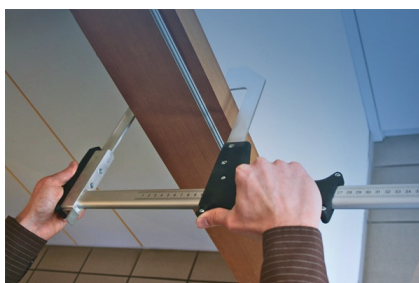
Dokładny pomiar grubości ścianki poprzez uchwycenie wokół uchwytu drzwiowego
