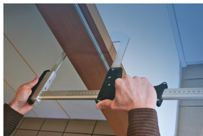
Exaktes Messen von Wandstärken durch Umgreifen des Türfutters
