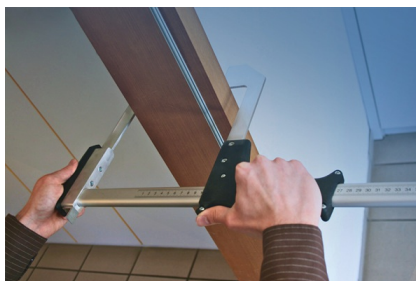
Exacte meting van de wanddikte door het grijpen rond de deurklem
