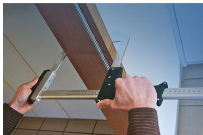
**Misurazione esatta dello spessore della parete tramite la presa intorno al mandrino della porta**
