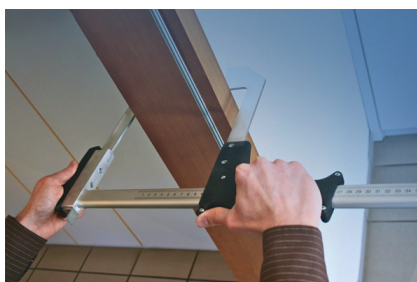
Medición exacta del grosor de la pared mediante sujeción alrededor del mandril de la puerta
