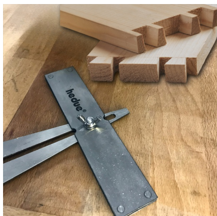
Latura reglabilă are o înclinare de 1:8
