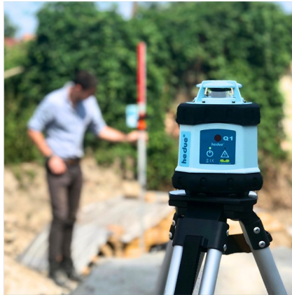
Kan worden gebruikt op statieven en muurbevestigingen met 5/8" schroefdraad.
