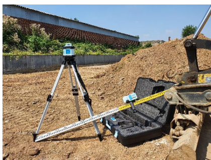
Komplettes Set zum Nivellieren im großen Koffer mit Stativ und Messlatte.
