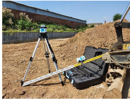
Tripod ve Mira ile büyük bir çantada tesviye için komple set.
