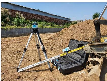
**Kit complet pour le nivellement dans une grande mallette avec trépied et toise.**
