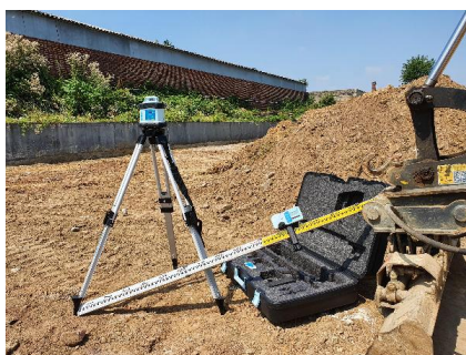
Set complet de nivelare într-o cutie mare, cu trepied și suport de măsurare.
