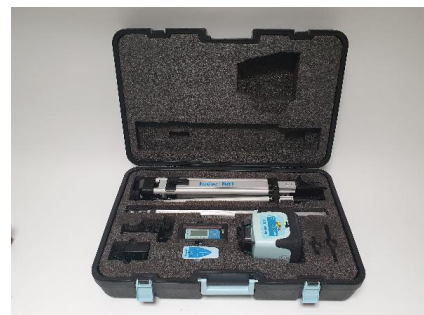
Komplettes Set zum Nivellieren im großen Koffer mit Stativ und Messlatte.
