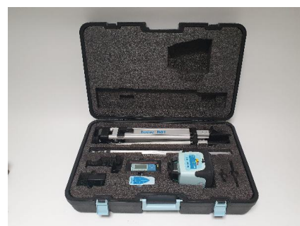
Complete nivelleerset in een grote koffer met statief en meetlat.
