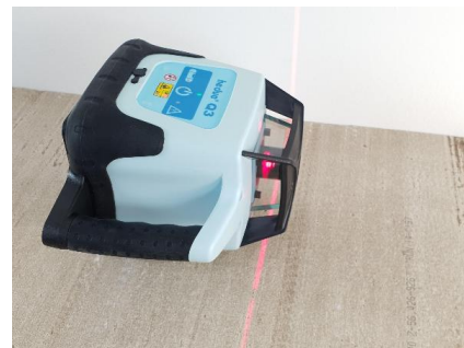
Autolivellamento orizzontale e verticale con servomotori fino a 5° di inclinazione.
