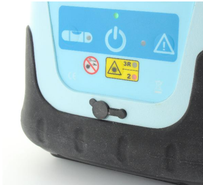
Sınıf II ve 3R arasında değiştirilebilir lazer sınıfı.
