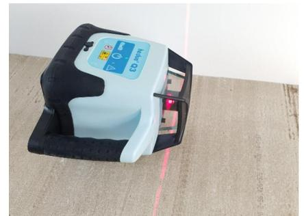
**Horizontale und vertikale Selbstnivellierung durch Stellmotoren bis 5° Schräge.**
