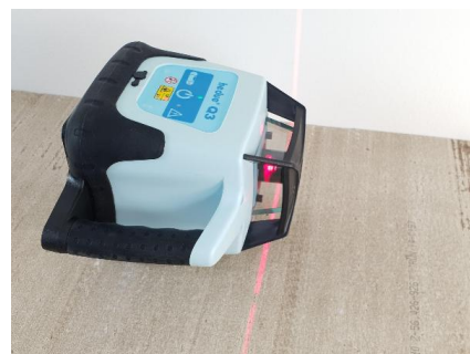
Autonivelamento horizontal e vertical por servomotores até 5° de inclinação.
