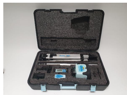
Conjunto completo de nivelamento numa mala grande com tripé e coluna de medição.
