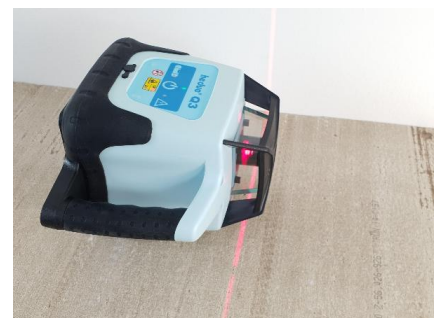
Mise à niveau automatique horizontale et verticale par servomoteurs jusqu'à une inclinaison de 5°.
