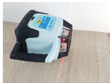
Auto-nivelare orizontală și verticală cu actuator de până la 5 °.
