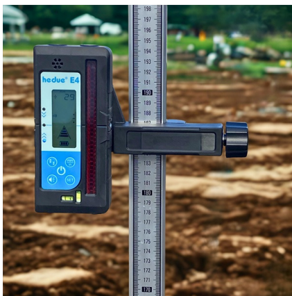
Receptorul cu laser digital arată diferența de înălțime față de linia laser în mm sau inci.
