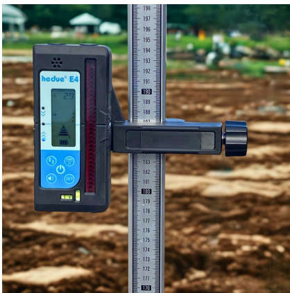
Der digitale Laser-Empfänger zeigt den Höhenunterschied zur Laserlinie in mm oder inch.
