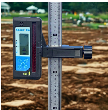
Le récepteur laser numérique indique la différence de hauteur par rapport à la ligne laser en mm ou en pouces.
